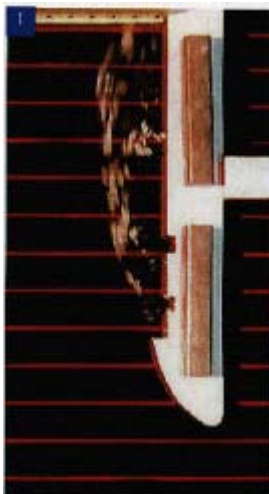
Obr. 1: Simulace proudění u stranových sloupků v plochem vodním kanálu.
